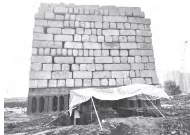
图1 核查某31500kN高吨位静载试验现场
